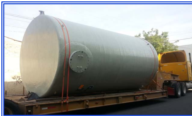
Tanque de almacenamiento de 60 m 3 PVDF/FRP de Nestlé Mexico
