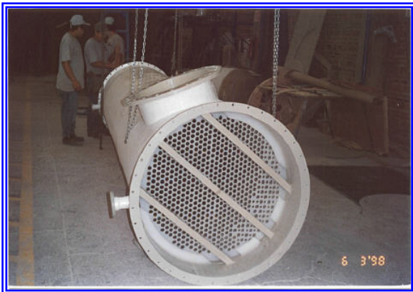
Torre de absorción de gases PVDF/FRP
