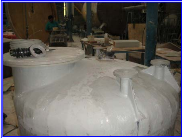
Refuerzo exterior del PVDF con FRP
