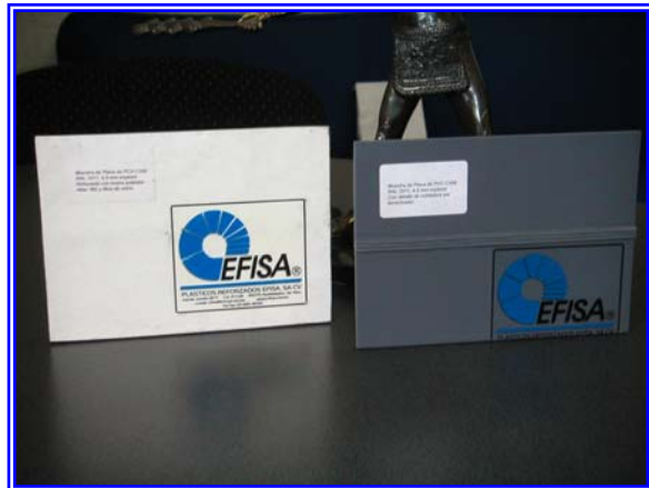
Acabado final del equipo Izquierda: acabado exterior con refuerzo de FRP Derecha: cara interior en contacto con fluido
