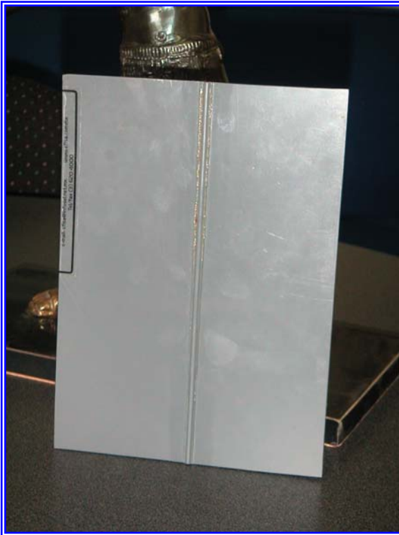
Detalle de cordón de soldadura interior
