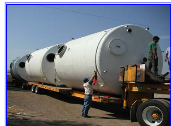
Embarque de 3 tanques de 50 m³ de PVC/FRP
