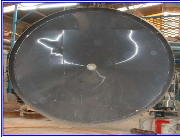
Fondo de un tanque terminado
