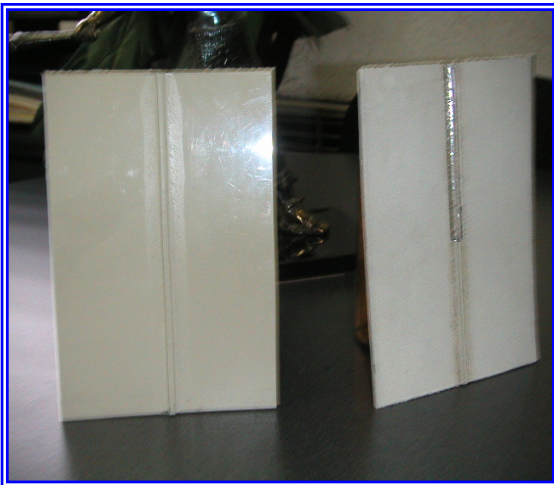
Placa de polipropileno de 3 mm espesor Izquierda: cara interior Derecha: cara exterior con respaldo sintético
