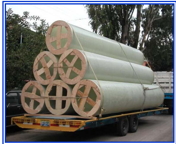
Tubería de 36"Ø para agua
